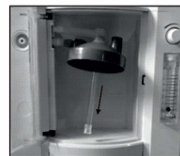
Рис. 61 – Интерфейс скорости потока, где: 1 – шкала (направление) изменения скорости потока; 2 – регулятор скорости потока; 3 – индикатор скорости потока; 4 – поплавковый шарик.
